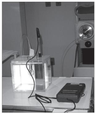
**Figura 1.** Sistema de dosimetria Fricke desenvolvido pelo CRCN para braquiterapia com altas taxas de dose.
