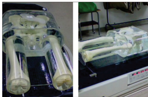
Figura 6. Objeto simulador utilizado para o estudo da interferência de próteses metálicas nas doses radioterápicas utilizadas no decorrer de um tratamento de câncer de próstata.
