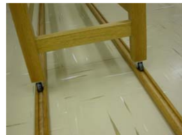
Figura 2. Sistema de 2 trilhos fixados no piso para permitir o deslocamento do banco óptico ao longo do feixe de raios X.
