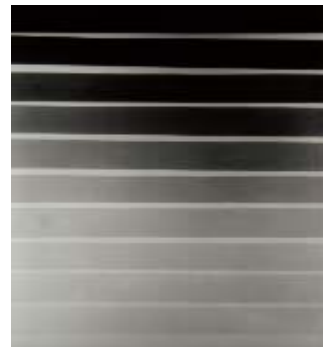
Figura 4. Densidades óticas geradas no filme pelo sensitômetro de raios X de intensidade escalonada. Cada faixa de densidade ótica foi gerada de acordo com os valores de exposição apresentados na Tabela 1.
