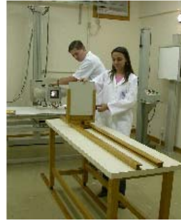
Figura 1. Sensitômetro de raios X de intensidade escalonada.
