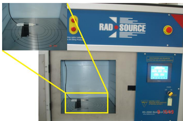
Figura 1. Esquema experimental utilizado no irradiador RS 2000
