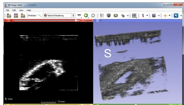
**Figura 5.** Renderização do volume rastreado utilizando a técnica pulso-eco (ultrassonografia convencional)
