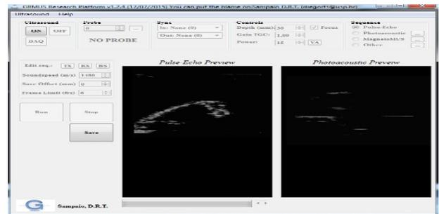
**Figura 4.** Software dedicado para aquisição de imagens de RF em modo pulso-eco e fotoacústica.
