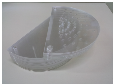
Figura 1. Simulador homogêneo de acrílico (PMMA) confeccionado com várias placas de 2 e 1 mm de espessura. Algumas placas possuem orifícios para acomodação de dosímetros TL e OSL.
