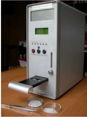
Figura 1. Leitora RA'04 TLD Reader-Analyser com TLDs em forma de chip a sua frente.
