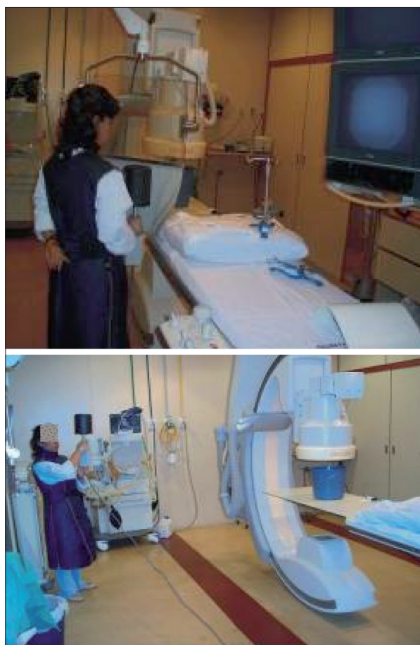
Figura 15. Procedimento de medição da radiação espalhada, com câmara de ionização de grande volume, em diferentes pontos da sala para a elaboração de curvas de isodoses.
