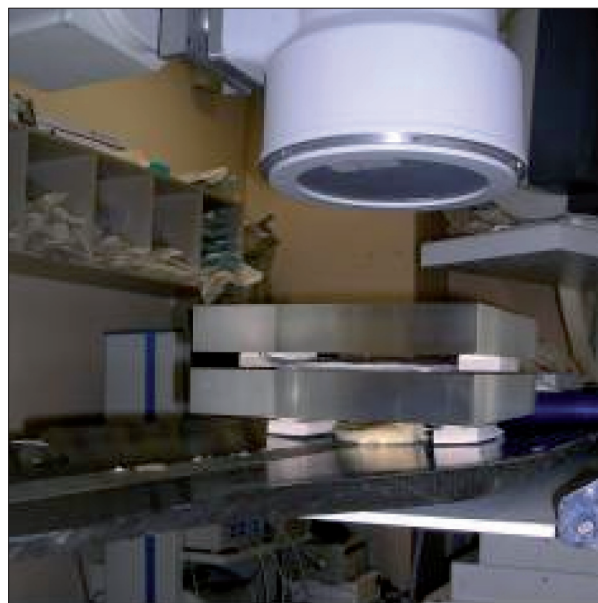
Figura 9. Posicionamento da câmara de ionização de referência para medir a taxa de kerma de entrada (sobre a mesa, embaixo da lâmina de PMMA) e avaliar aspectos relacionados à qualidade da imagem com objeto de teste colocado entre as duas placas de PMMA.
