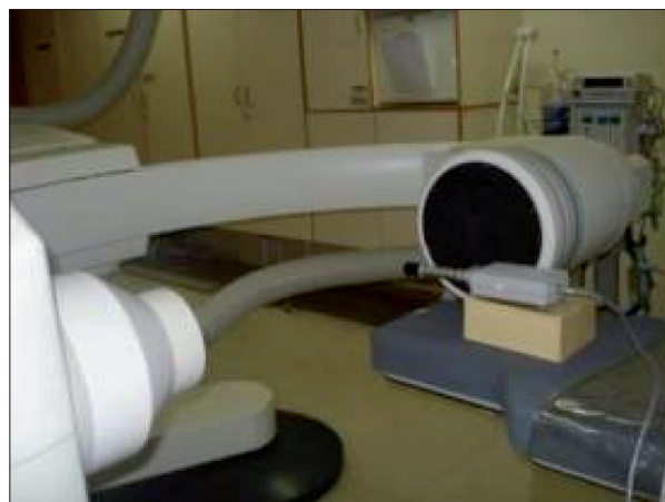
Figura 8. Posicionamento da câmara de ionização de referência para medir a taxa de kerma no ar, para diferentes kVp, a fim de determinar o rendimento do tubo de raios X.
