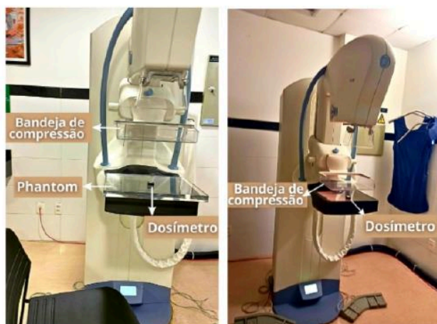
Figura 8. Dosímetros de BeO irradiados a distâncias diferentes da bandeja de compressão, com (à esquerda) e sem (à direita) o phantom .
