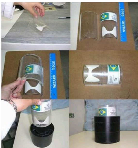
Figura 2. Simulador de tireoide-pescoço desenvolvido no IRD. Fonte: Oliveira et al.
