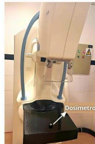
Figura 7. Mamógrafo GE- modelo Seno essencial digital com o dosímetro posicionado sobre o suporte para a mama.
